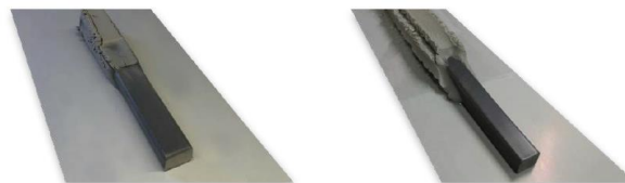
Expansión de Quellmax ® Blackstop 18x24 a las 3 y 24 horas después de la hidratación
